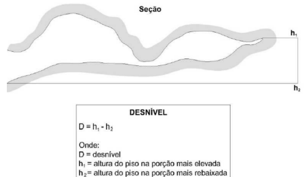
Figura 4 – Medição de desnível numa cavidade.
